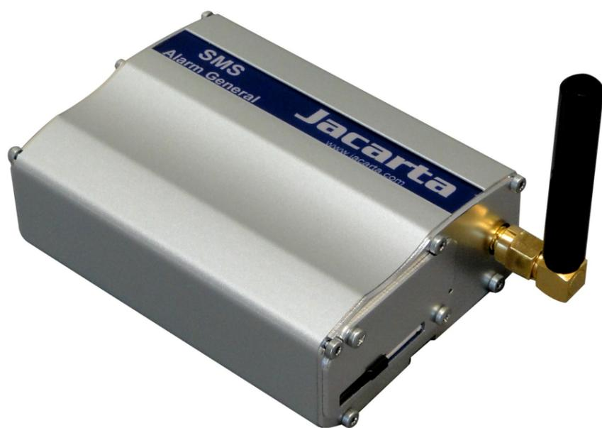
Con la possibilita' di collegare fino a due sensori, Alarm General utilizza tutti i sensori Go Probe Jakarta. E' anche possibile collegarlo direttamente a pannelli di allarme quali, fuoco, sicurezza, generatori, UPS, aria condizionata etc ....
