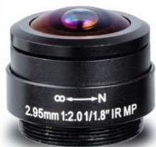
Ottica "CS" fino a 3Mp per sensore 1/1.8", da 2.95mm  $f$  2.0, IRIS manuale con filtro IR
