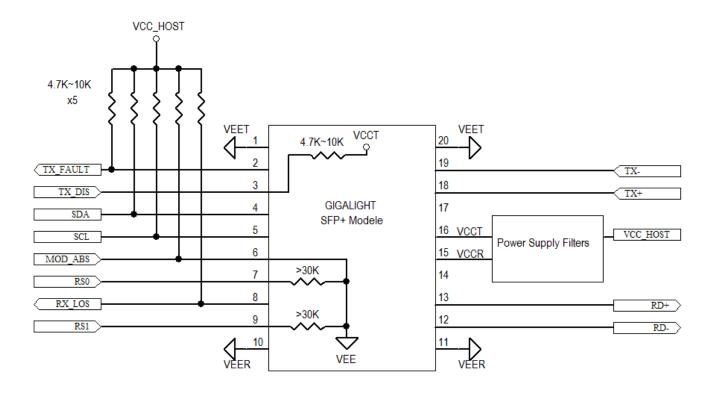
Figure 4. Host-Module Interface
